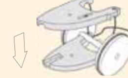
Stecke die Schraube von unten durch den Korpus und schraube die Kugel auf und stecke die Deichsel mit dem Vorderrad ein.
